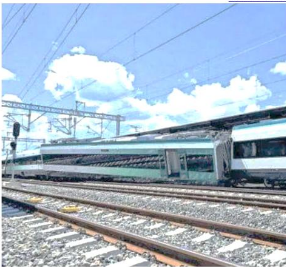
El vagón quedó inclinado sobre la vía de la estación Izamal
